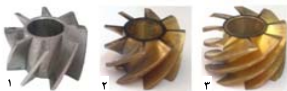
شکل ۱- پره‌های چرخاننده: (۱) ۳۰درجه، (۲) ۴۵درجه، (۳) ۶۰ درجه
