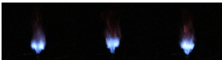
شکل ۴- عکس‌های میانگین‌گیری شده از شعله توسط دوربین در سرعت شاتر ۱/۳۵۰ ثانیه
