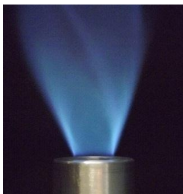
Figure 11- Fully attached flame شکل ۱۱- شعله در حالت اتصال کامل به دهانه نازل مشعل
