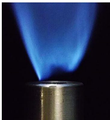
Figure 10- Partially attached flame شکل ۱۰- شعله در حالت اتصال جزئی
