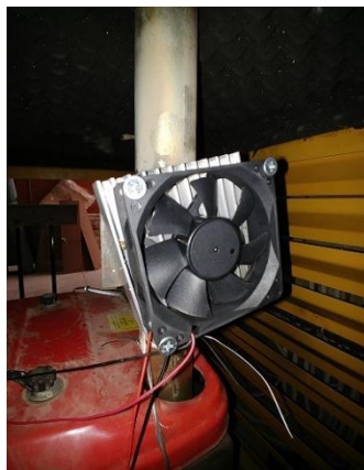
Figure 3- Exhaust thermoelectric waste heat recovery system شکل ۳- سامانه بازیافت حرارت ترموالکتریک اگزوز
