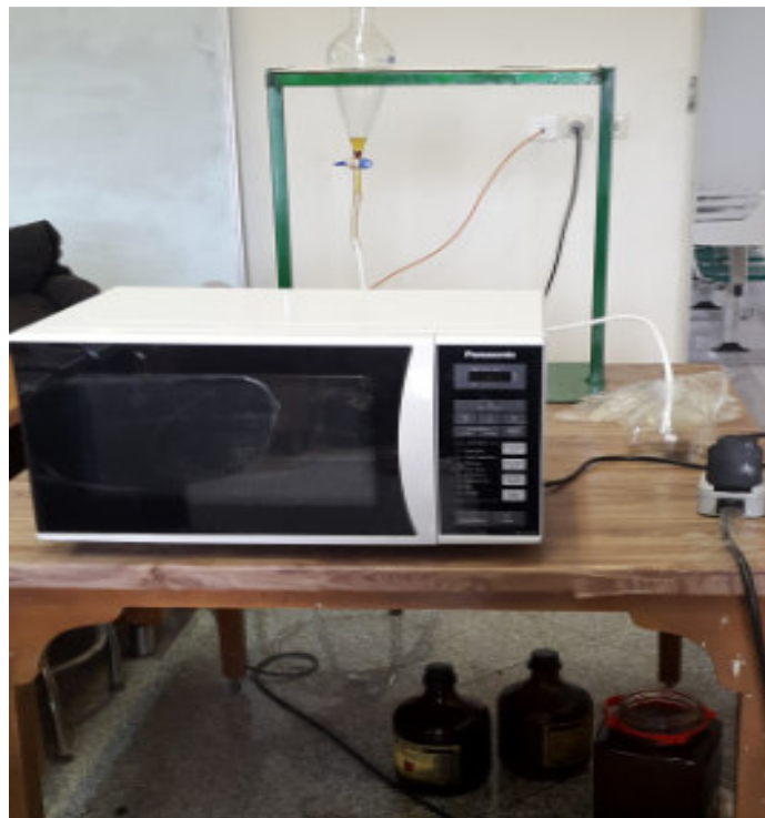
Figure 1- The experimental set-up used in this study for biodiesel producing شکل ۱- طرحواره مورد استفاده در این تحقیق برای تولید بیودیزل
