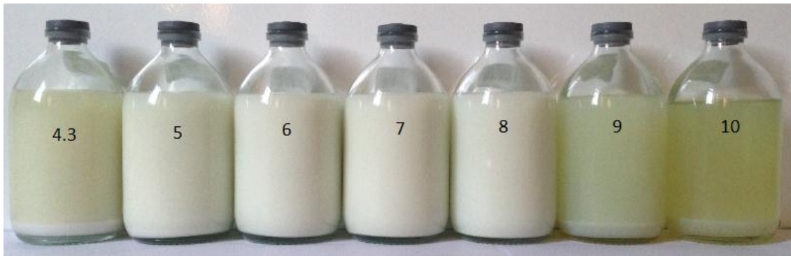
شکل ۴- امولسیون با HLB های مختلف بعد از سه روز نگهداری در دمای محیط (اعداد داخل تصویر، عدد HLB همان نمونه است). Figure 4- Emulsion with different HLBs after three days of storage at ambient temperature (numbers inside the image, is the HLB number of same sample)
