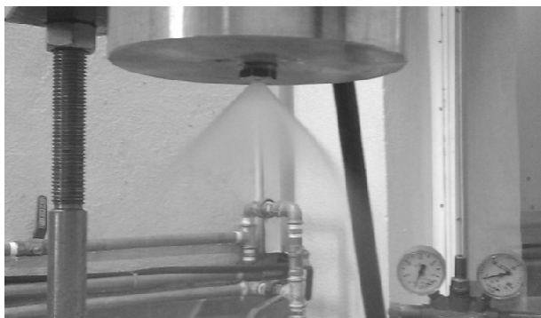
شکل ۱۱- تصویر پاشش سیال از انژکتور ساخته شده
