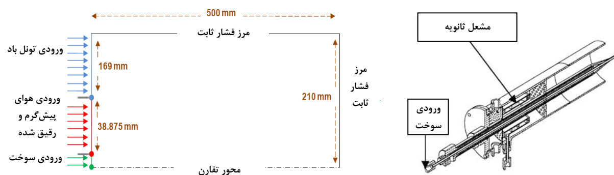
شکل ۱- مشعل مورد استفاده دالی (JHC) [۲۲] شکل ۲- هندسه به کار رفته در مدلسازی عددی (شکل مقیاس نشده است)
