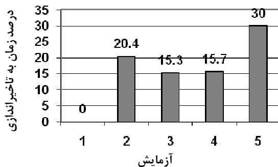
شکل ۴- اثر ذرات نانو بر روی زمان گسترش شعله- نفت سفید
