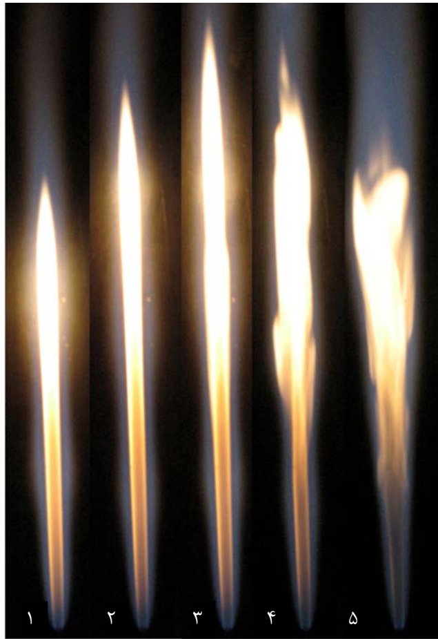
شکل ۴- تغییرات شکل شعله‌ی گاز طبیعی با سرعت تزریق سوخت و برای رقیق سازی اکسیژن با نیتروژن. جریان اکسیدکننده شامل ۶۰ درصد مولی اکسیژن و ۴۰ درصد مولی نیتروژن است.
