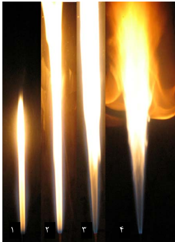
شکل ۱۰- تغییرات شکل شعله‌ی پروپان با سرعت تزریق سوخت و برای رقیق سازی اکسیژن با نیتروژن. جریان اکسیدکننده شامل ۶۰ درصد مولی اکسیژن و ۴۰ درصد مولی نیتروژن است. (۱) Re_{Propane}=1879 ، (۲) Re_{Propane}=2369 ، (۳) Re_{Propane}=7066 ، (۴) Re_{Propane}=16500
