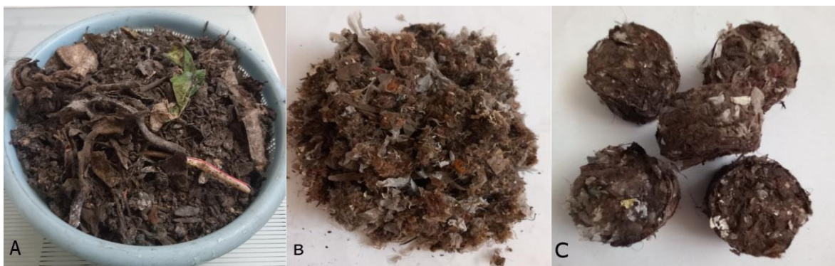
Figure 3- Solid fuel sample (C) from fluff-like materials (B) derived from reject materials (A) of the Rasht organic fertilizer factory شکل ۳- نمونه سوخت جامد (C) از مواد کرک مانند (B) مشتق شده از مواد دورریز (A) کارخانه کودآلی رشت
