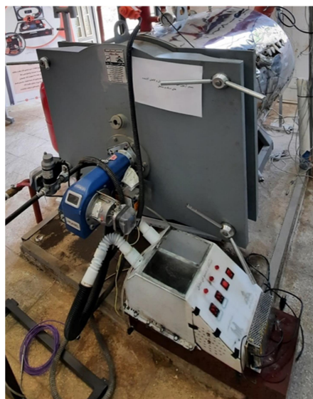
Figure 1- Gas burner, boiler and nebulizer used in the experiment شکل ۱- مشعل گازسوز، بویلر و دستگاه نبولایزر مورد استفاده در آزمایش
