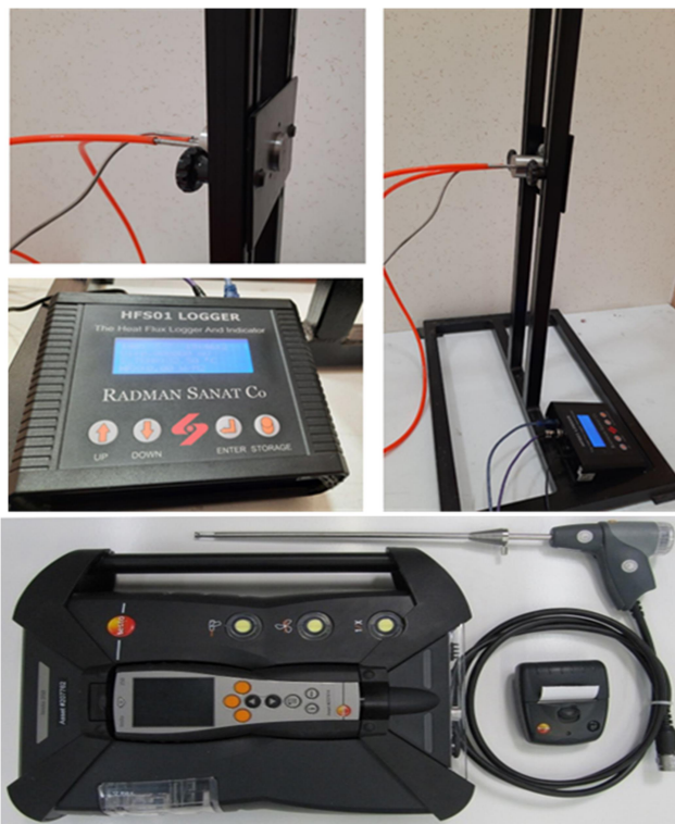
Figure 3- Heat flux sensor HFS01 and TESTO 350 gas analyzer شکل ۳- سنسور شار حرارتی HFS01 و دستگاه آنالیزور گاز TESTO350
