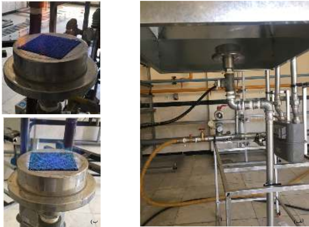
شکل ۱ الف) تصویر بستر آزمون با تمرکز بر استقرار مشعل در دودکش ب) پایدارسازی شعله روی مشعل با دبی‌های هوای ۱۳ و ۱۸ مترمکعب بر ساعت (به ترتیب شکل بالا و پایین)
