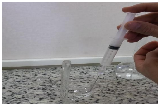
Figure 2- Einhorn container for measuring methane شکل ۲- ظرف آینه‌هورن برای اندازه‌گیری متان
