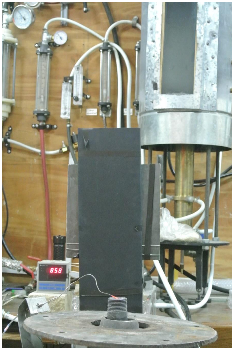
Figure 3- The nozzle exit, thermocouple, air and fuel rotameter شکل ۳- نازل خروجی، ترموکوپل و روتامترهای سوخت و هوا
