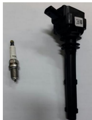
Figure 11- a) Spark array mounted on the chamber, b) Spark plug and plug شکل ۱۱- الف) سیم‌پیچ جرقه سوار شده بر روی محفظه و ب) سیم‌پیچ جرقه و شمع مورد استفاده
