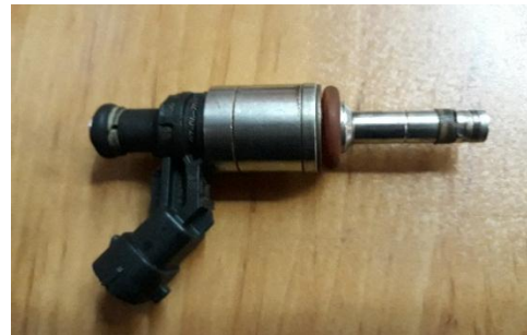
Figure 10- Spray used to spray methane into a closed chamber شکل ۱۰- افشانه مورد استفاده برای پاشش متان به داخل محفظه بسته
