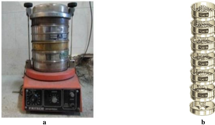
Figure 5- a) Vibrating screen in the laboratory, b) Demonstration of how particles pass through the screen شکل ۵- الف) سرنند لرزاننده موجود در آزمایشگاه و ب) نمایشی از نحوه عبور ذرات از سرنند
