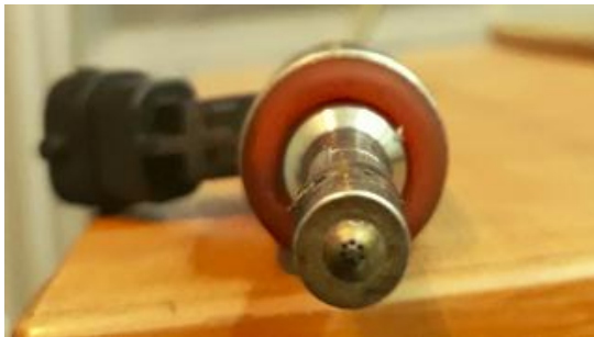
Figure 10- Spray used to spray methane into a closed chamber شکل ۱۰- افشانه مورد استفاده برای پاشش متان به داخل محفظه بسته
